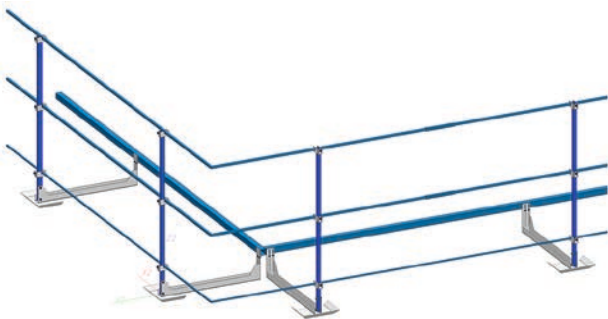
Bild 5 Geländer ohne Dachhautdurchdringung; wird an der Unterkonstruktion der Photovoltaikanlage stabilisiert
